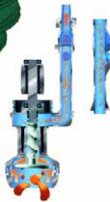
Skruvpump med flexibel stator för driftsäker funktion
