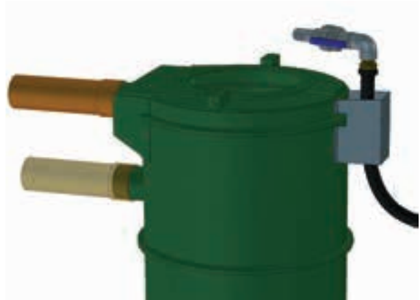
2. Montera utloppsventilen på utgående tryckledning. Centrum på ventilröret skall ligga ca 14-15cm över pump-sätet.
