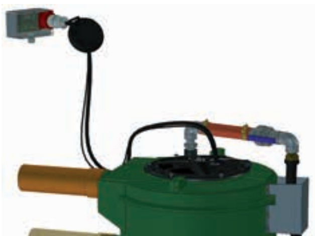
5. Se till att utloppsventilen och eventuell servisventil vid tomtgräns är öppen. Anslut pumpens stickpropp till apparatlådan. Fäst tryckutjämnaren på kabeln.
